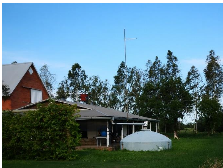
Fotografía 12. Sistema domiciliario de cosecha de agua con aljibe prefabricado de fibra de vidrio
