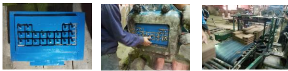
Proceso de producción, boquillas, moldeado de la materia prima.
