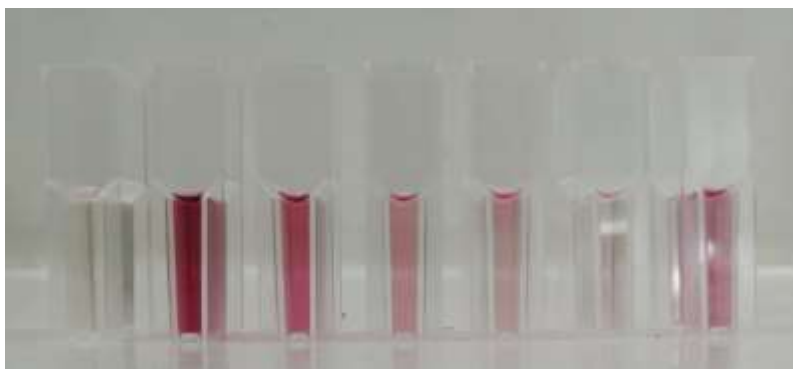
Figura 11: Soluciones correspondientes al método de cuantificación de glucosa. Se muestran las soluciones luego de las reacciones a partir de las cuales se genera quinonimina coloreada. BCO, corresponde al blanco de reacción (agua); ST, corresponden a los niveles de calibración (diferentes concentraciones de estándar); MC, corresponde a la muestra control (solución testigo de glucosa 1,5 g/L).
