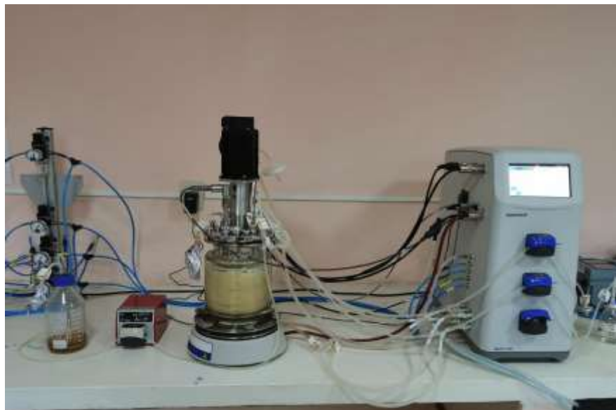
Figura 14: Biorreactor de tanque agitado de 2 litros (Bioflo 120) de Eppendorf en funcionamiento.
