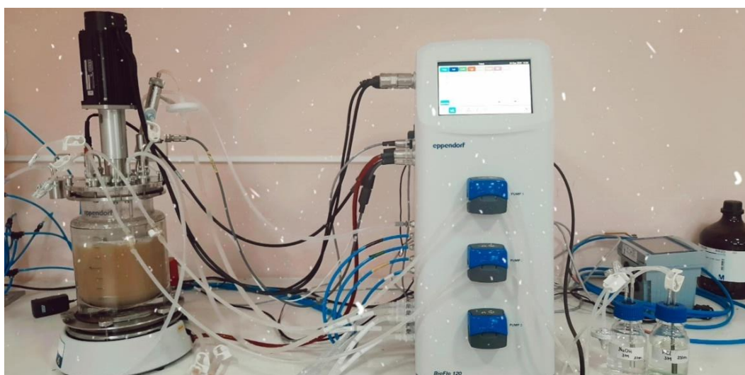
Figura 15: Bioreactor de tanque agitado BioFlo 120 de Eppendorf.
