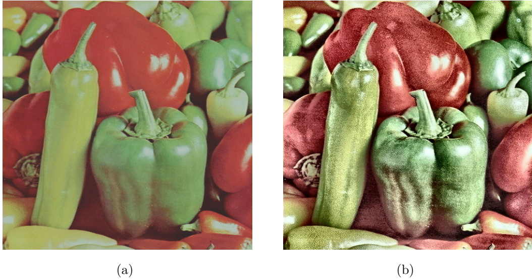
Figura 2.11: Datos de SSIM para una imagen de ejemplo. En (a) SSIM_R = 1 , SSIM_G = 1 , SSIM_B = 1 en (b) SSIM_R = 0,484719 , SSIM_G = 0,525963 , SSIM_B = 0,533241
