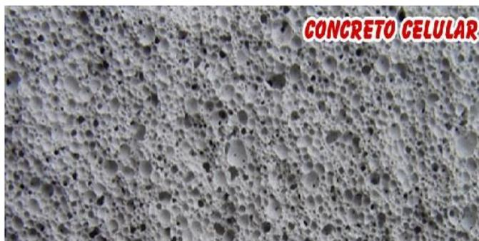
Figura n°1. Composición de concreto celular
