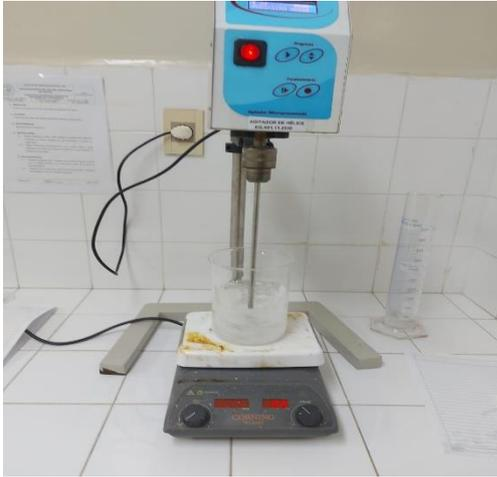
*Imagen 1. Proceso de elaboración del Gel base. Dispersión del Carbopol en medio acuoso*
