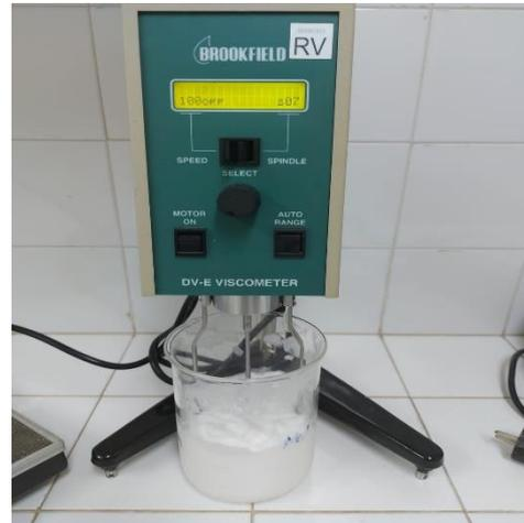
*Imagen 2. Medición de viscosidad utilizando un Viscosímetro de Brookfield*
