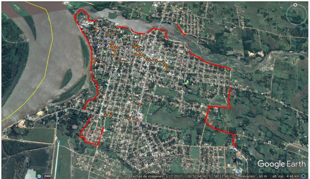
Figura 9. Diques de Contención construidos en el perímetro de la Ciudad (Rolón, 2000)
