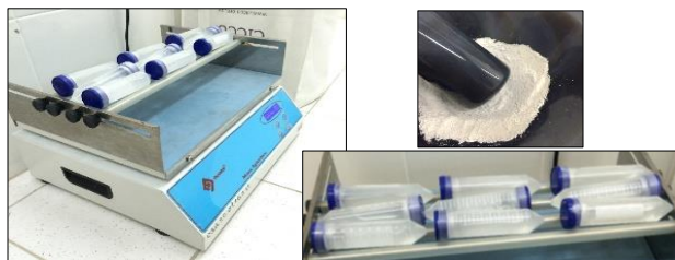
Fig. 1. Materiales utilizados en el ensayo: (a) muestra en polvo de hidroxiapatita, (b) frascos bajo agitación y (c) mesa agitadora.
