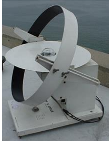
Figura 3.5: Piranómetro con banda de Sombra. Fuente: Instalaciones Solares Fotovoltaicas, Jose Labarta
