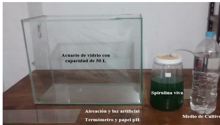
Figura 23. Instalación del módulo de cultivo. Fuente: Propia.
