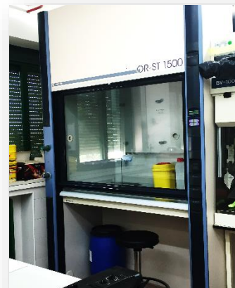
Campana de extracción
